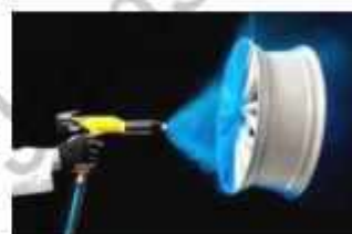
Fig: 14.14 Spray paint
